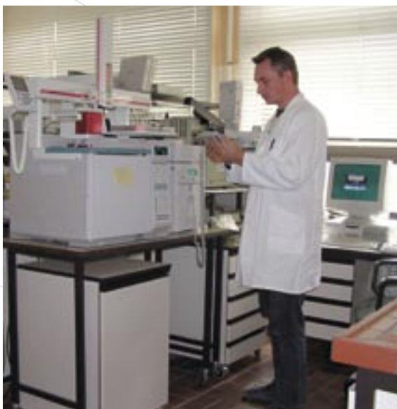
Gaschromatograph zur Bestimmung von Benzol
