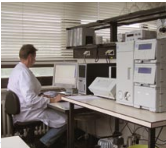
Auswertung am Ionenchromatograph zur Bestimmung von Bromat und anderen Anionen
